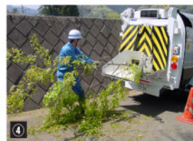
④ チッピングロータリープレス車による 収集と粗破砕
